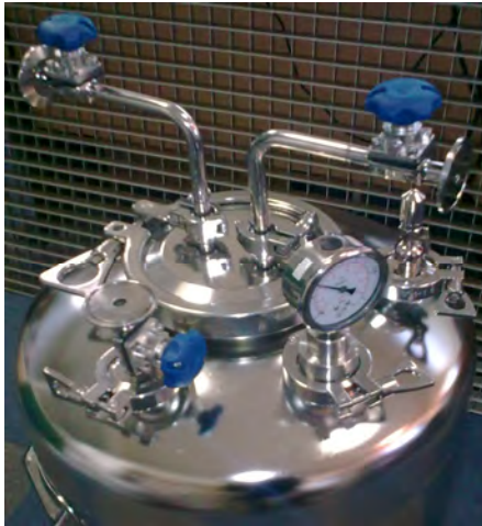
Dome de cuve avec divers piquages
